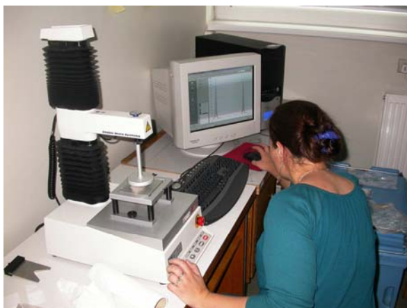
Obr. 38 a 39. V rámci hodnocení kvality finálního produktu byla měřena i textura filet bez kůže na texturometru TA.XT Plus
