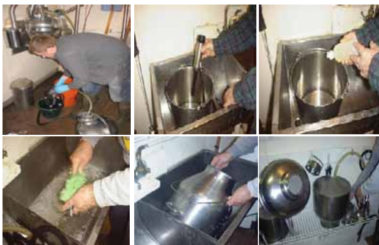
Pranje uređaja za mužu, glavno pranje, ispiranje i dezinfekcija
