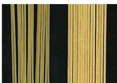
**Aspect de surface:** dépend de la nature du moule d'extrusion:
